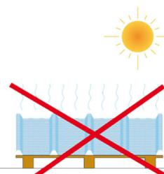
Für Lichtplatten gilt: nicht übereinander gestapelt dem Sonnenlicht aussetzen. Stets unter einer Plane lagern!
