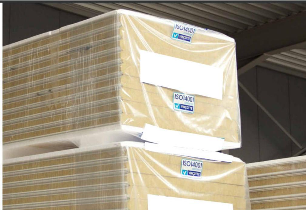
Auf der Baustelle sind die Produkte auf einem festen, trockenen Untergrund und an einem belüfteten Ort (überdachter Lagerraum, Schuppen, überdachter Teil des Baus usw.), geschützt vor Sonne, Regen, Schnee und schädlichen Dämpfen, zu lagern.
