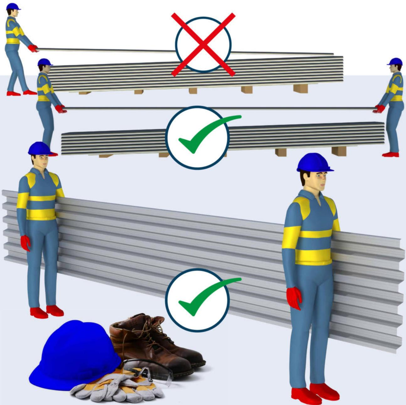
Isolierpaneele sollten so gehandhabt werden, dass sie nicht an den Kanten angefasst werden. Sie sollten vorzugsweise hochkant und mit der Männlein-Seite nach unten (Verzahnung) gehoben werden. Paneele, die im Vergleich zu ihrer Dicke relativ lang sind ( $L > 100 \times \text{Dicke}$ ), müssen beim Transport unbedingt auf ihre Kante gekippt werden, um Bruchschäden zu vermeiden.
