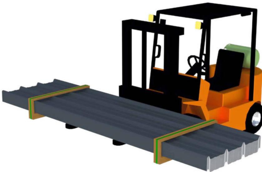
Das Abladen von Paketen mit Profilen und Hochprofilen durch einen Gabelstapler folgt denselben Prinzipien wie das Abladen der Isolierpaneele (S. Seite 15). Allerdings sollten zwischen die Gabeln und Produkte Holzelemente gelegt werden.
